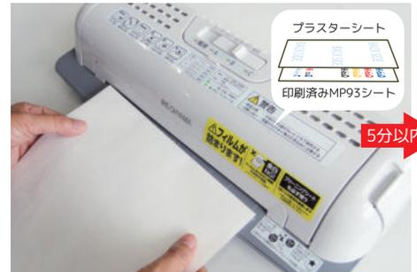
① MP93シートのツルツルした面にレーザープリンタで印刷。
